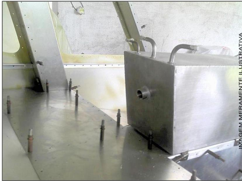
*Tanque de glissada instalado no Stol CH 750*
